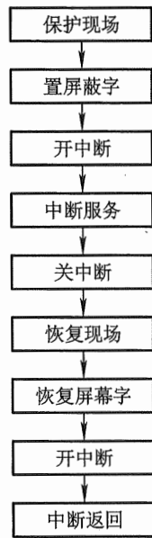
图 8.36 采用屏蔽技术的中断服务程序
